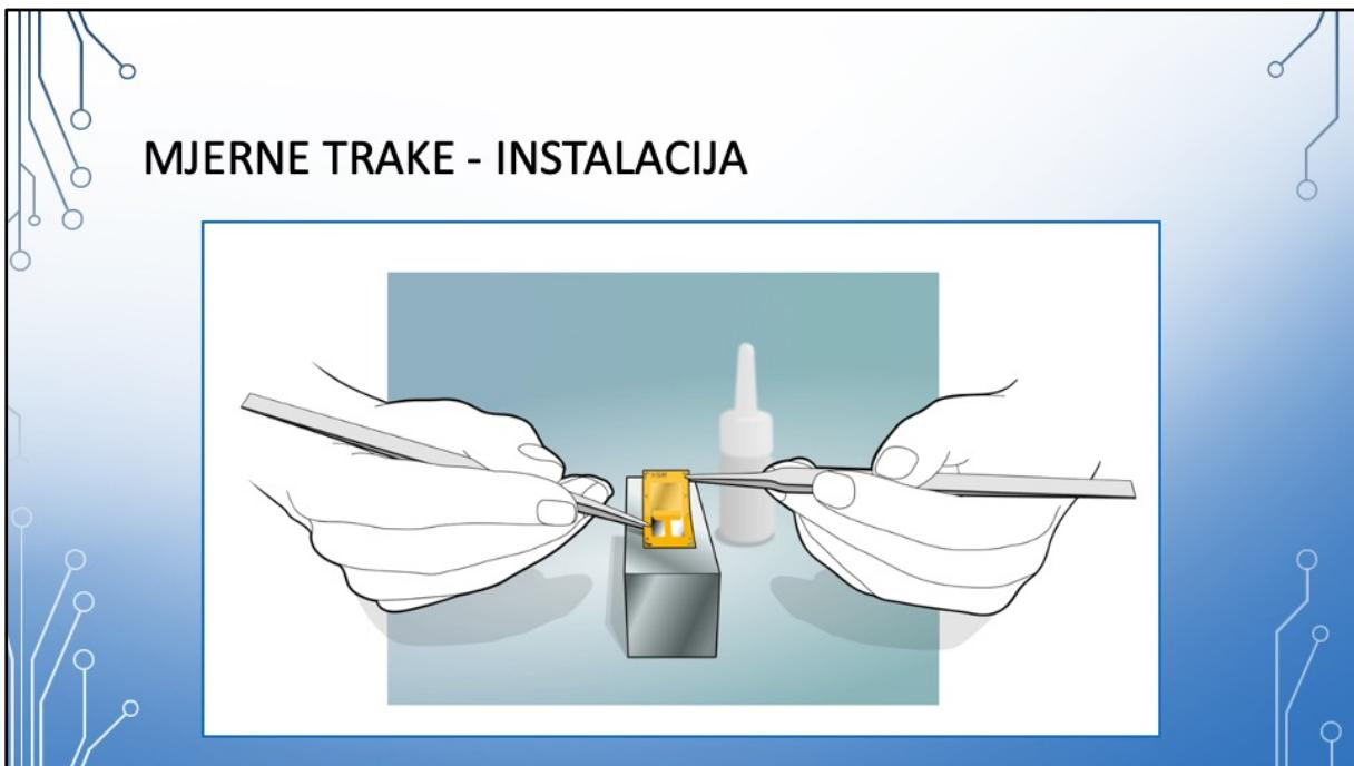
Mjerne trake se postavljaju na objekat čija se deformacija mjeri uz poštovanje odgovarajuće procedure koja je pogodna za većinu senzora naprezanja.
